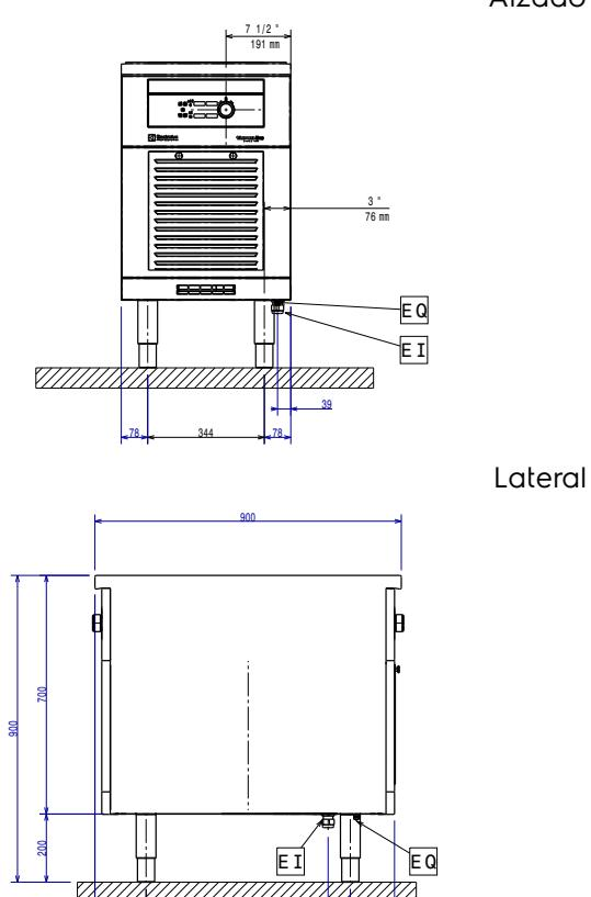
El = Conexión eléctrica (energía)
